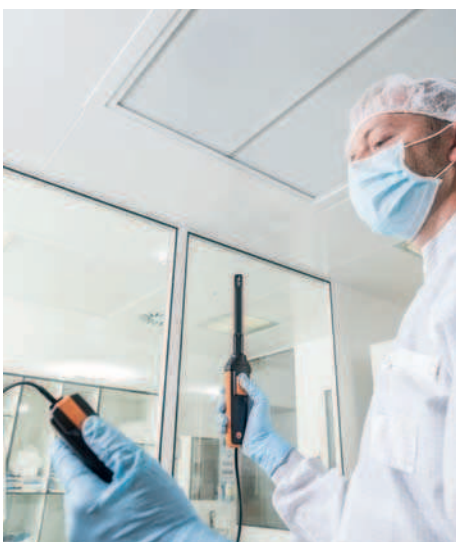
Вам нужно провести измерения там, где использование Bluetooth невозможно? Нет проблем: просто подключите зонд-наконечник к рукоятке с кабелем вместо рукоятки с Bluetooth, и вы готовы к работе
